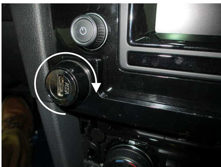
Draai met de sleutel de beugel vast en neem daarna de sleutel er uit
