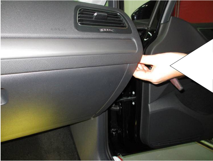
Verwijder aan de zijkant 1 x torx schroef
