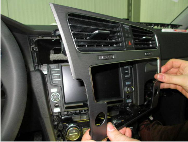
Verwijder voorpaneel radioconsole
