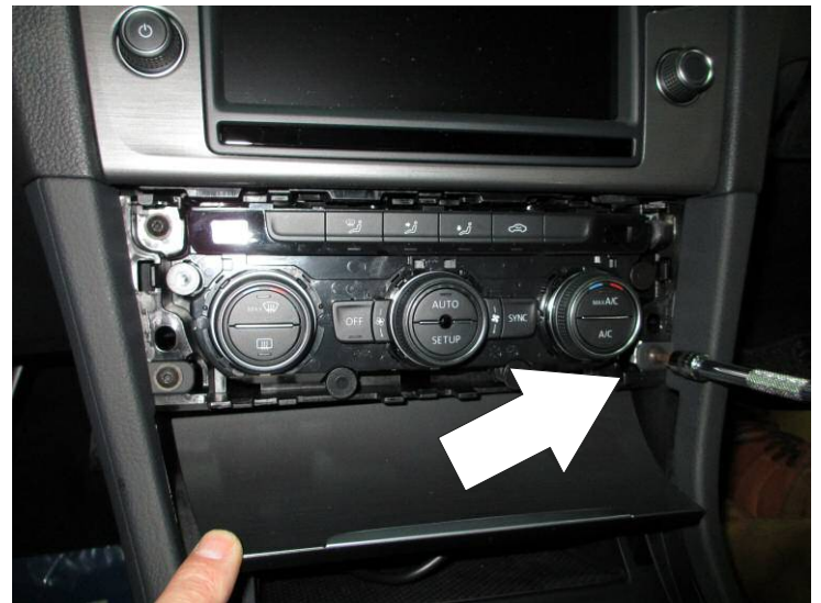
Verwijder torx schroef rechts van middenconsole
