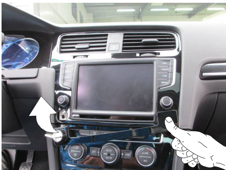
Monteer de veiligheidsbeugel door rechts in het gat te steken en daarna links omhoog te draaien
